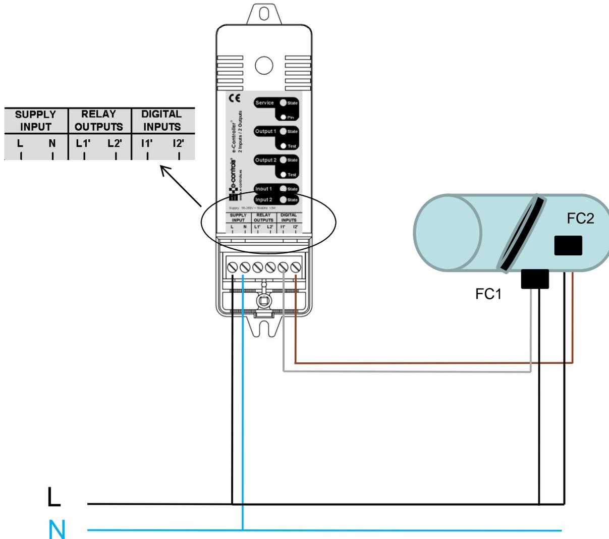
Los sensores de estado de las compuertas se conectan a las entradas digitales del e-Controller para detectar su estado y enviar la información a una aplicación remota tipo SCADA en instalaciones con BMS, para su monitorización en un ordenador.
